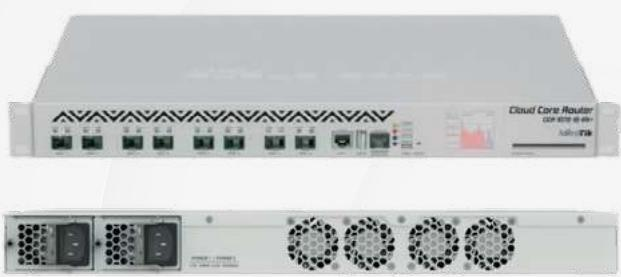
» **Cloud core router mikrotik CCR1072-1G-8S+**
